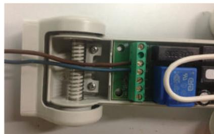
Collegare i cavi dell'alimentazione alla centralina integrata nel sensore.
