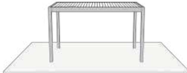
Installare le basi di fissaggio della colonna (Fig. 2) sulla superficie, correttamente allineate e squadrate. A tal fine, è necessario misurare le diagonali necessarie per le dimensioni della pergola. Assicurarsi che entrambe le diagonali (A e B) abbiano la stessa dimensione e che la larghezza e la lunghezza siano corrette (Fig. 3). Avvitare saldamente a terra e verificare la resistenza.
