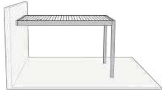
Installare le basi di fissaggio della colonna (Fig. 20) sulla superficie correttamente allineata e squadrata. A tal fine, misurare le dimensioni della pergola perpendicolarmente alla parete in cui verrà ancorata. Assicurarsi che entrambe le diagonali (A e B) abbiano le stesse dimensioni e che la larghezza e la lunghezza siano corrette (Fig. 21). Avvitare saldamente a terra e verificare la resistenza.
