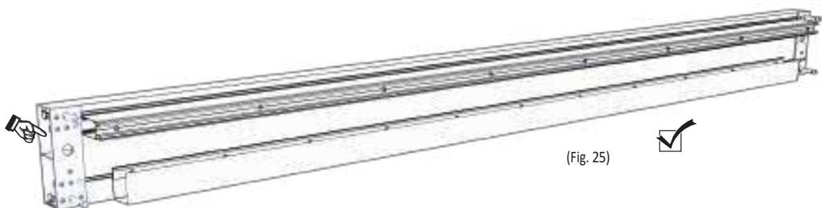
A2.6 Posizionare le tavole di compensazione, pressate e centrate sulle basi (che sono già posizionate sui travetti). Il listello di apertura viene posizionato con la fascia paraspifferi rivolta verso l'alto e il listello di chiusura viene posizionato sulla trave laterale di chiusura (Fig. 26).
